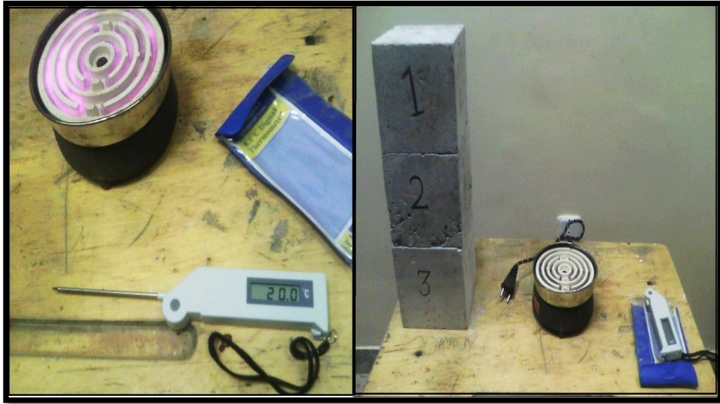
الشكل (5) : الأجهزة المستخدمة لقياس التوصيل الحراري للعينات
